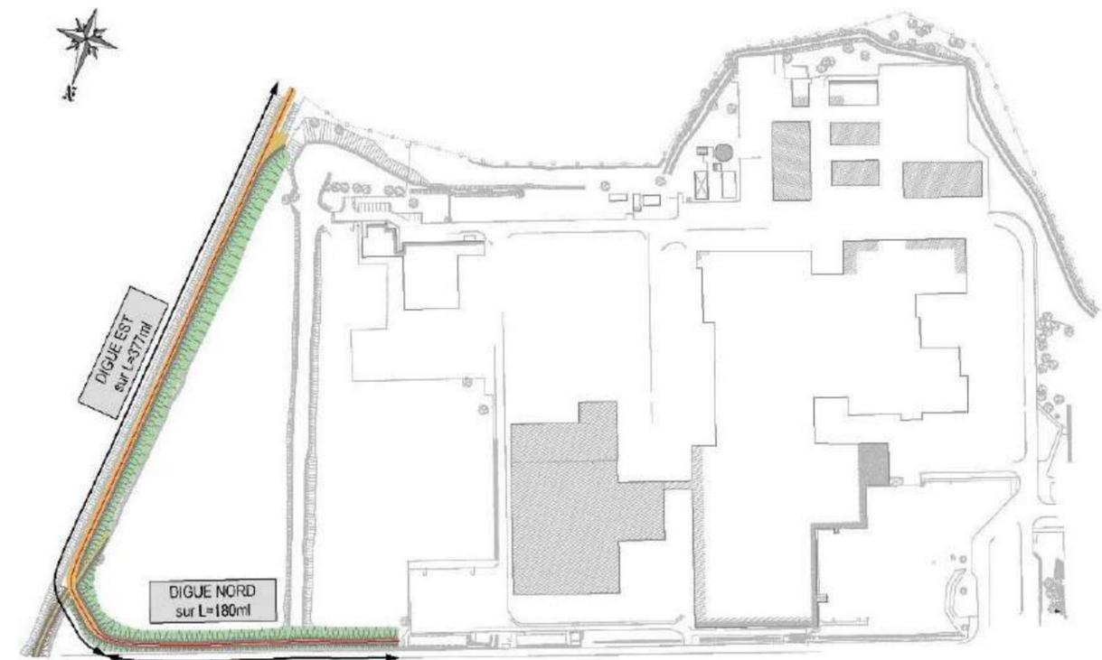
Emplacement des digues de l'ARC à réaliser
